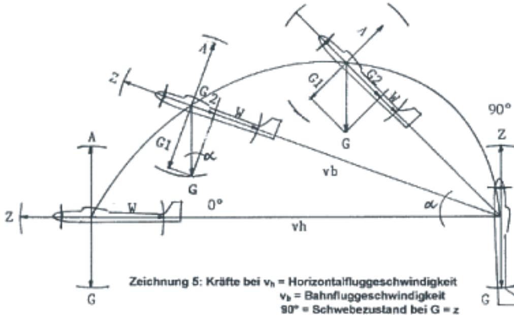
Eine ganz knifflige Angelegenheit ist die **Bahnfluggeschwindigkeit  $v_b$** . Sie ist die auch in Abbildung 4 gezeigte, von der horizontalen Flugbahn mehr oder weniger abweichende, also steigwinkelabhängige Geschwindigkeit. Leider ist sie für die Propellerberechnung von besonderer Bedeutung. Dort geht es beim wichtigen, so genannten Fortschrittsgrad, um den Quotienten aus Bahnfluggeschwindigkeit des Modells durch Umfangsgeschwindigkeit der Luftschraube.
