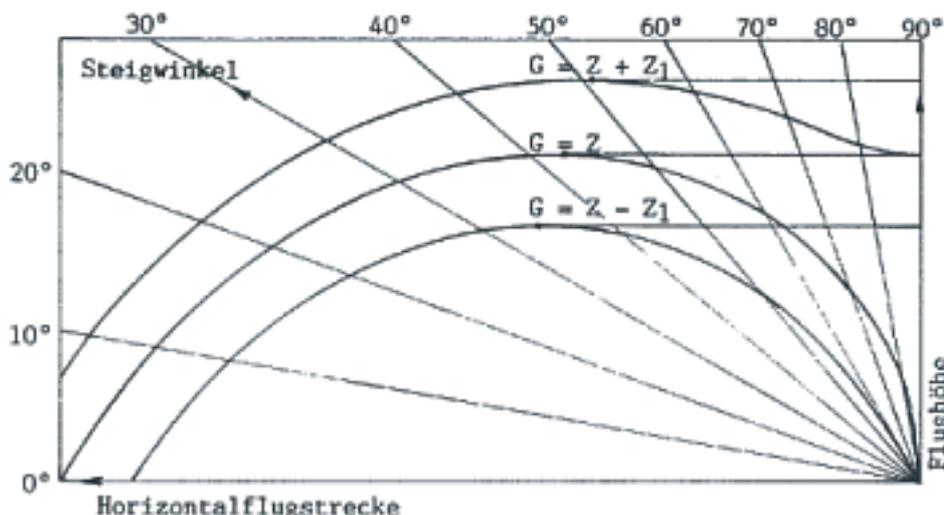
**Zeichnung 6: Flugbahnkurven von Modellen gleichen Gewichtes aber unterschiedlicher Propeller- bzw. Steigleistungen.**
