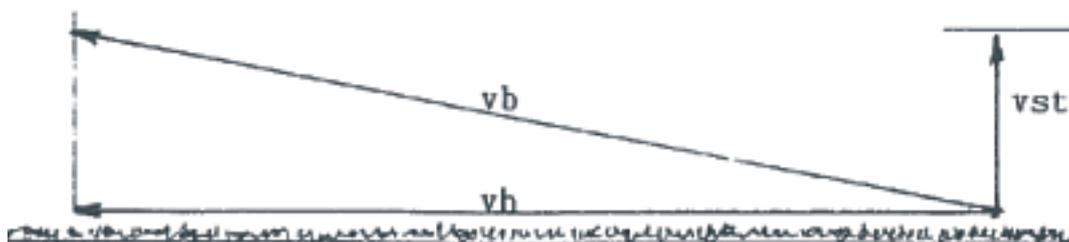
geschwindigkeit,  $v_b$  = Bahnfluggeschwindigkeit und  $v_{st}$  = Steigfluggeschwindigkeit, alle (m/s).
