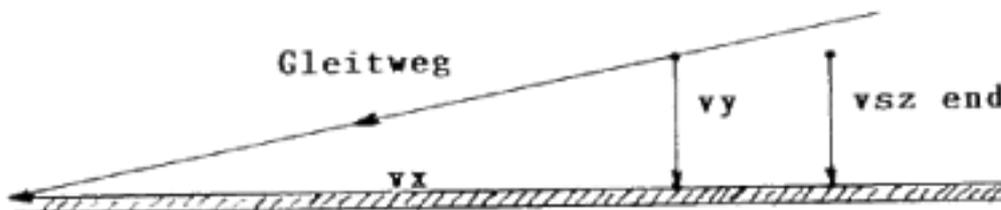
Legt ein Segler im Niedergleiten eine bestimmte Wegstrecke über Grund! pro Sekunde zurück, spricht man von der **Gleitfluggeschwindigkeit**  $v_x$  (m/s). Die Berechnung erfolgt also nicht nach dem Gleitweg, sondern mit den zurückgelegten Metern über Grund.
