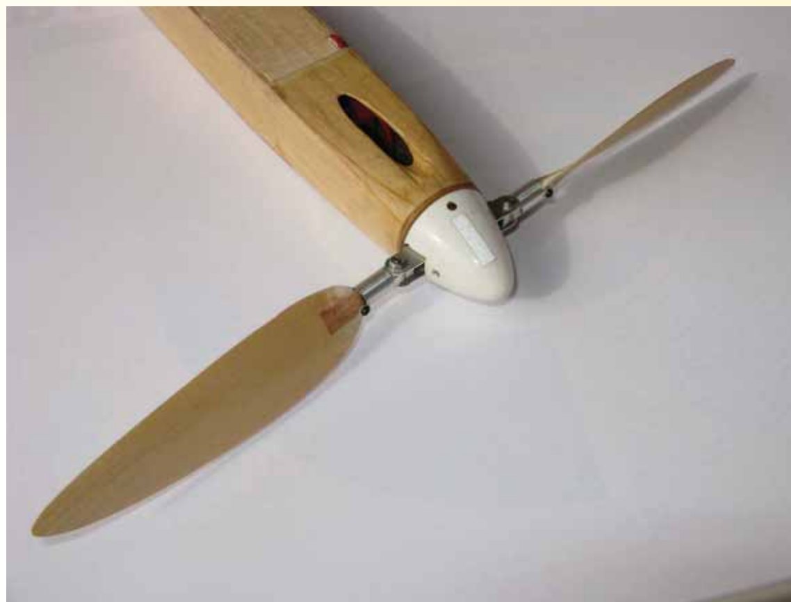
Propellermittelstück für leichten Blattwechsel- und Steigungs-Verstellmöglichkeit.
