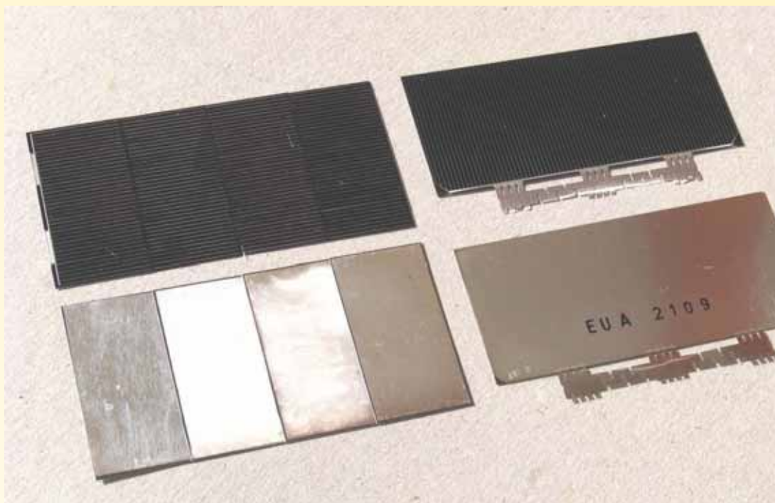
Zellenvergleich, Schindelstring zu RWE S 32 mit bizarrem Lötanschluss (Ober- und Unterseite)
