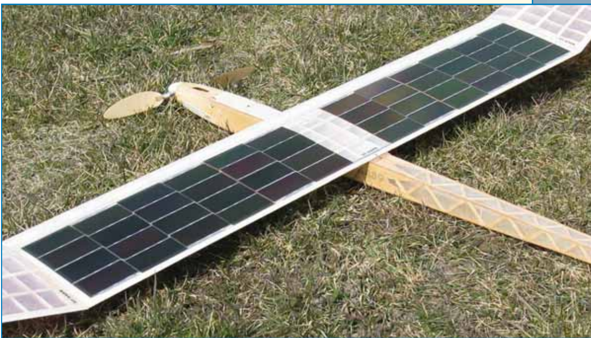
3 Paneele á 8,0 V zu je 16 Zellen ergeben das ungewöhnliche Belegungsbild der neuen Tragfläche Fotos O.Czepa und W. Wallner
